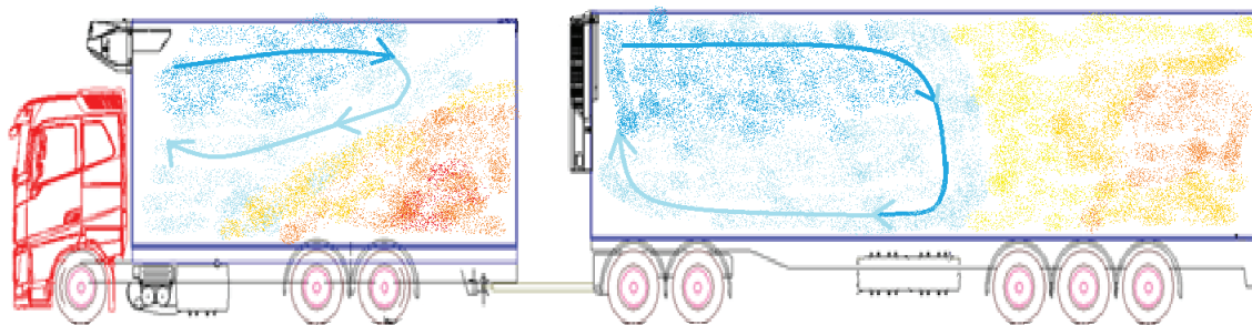
Kuva 5. Kaksi tyypillistä ilmankierron virhettä. Vetoautossa ilma kiertää ainoastaan kuormatilan yläosassa. Perävaunussa kuorma estää ilman puhalluksen takaosaan asti.
