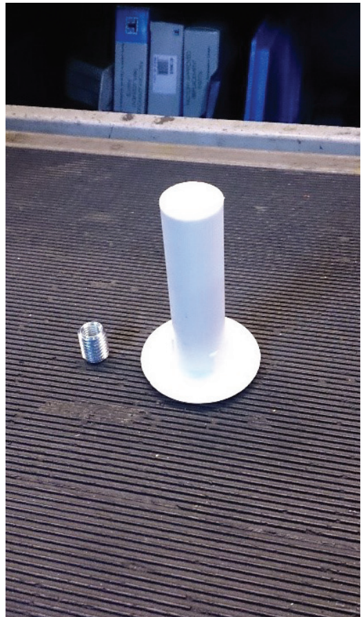
Kuva 15. Muovitulppa läpipulttauksen korjaukseen.
