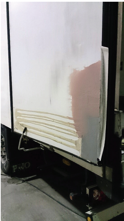
Kuva 7. Hiontavaiheessa oleva takaovi.
